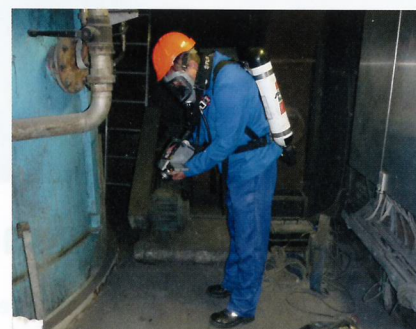
Bild 2: Arbeit mit der Gaskamera – auch unter Vollschutz möglich
