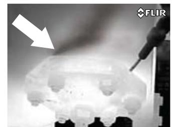
Der Schnüffler erkennt Gas, kann die Undichtigkeit jedoch nur mühsam aufspüren, wohingegen dieses Wärmebild die Leckagequelle links deutlich zeigt.
