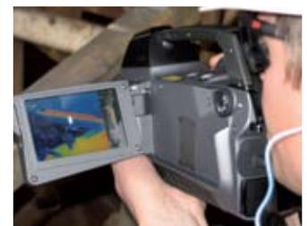
Schwenkbares, ausklappbares 4,3-Zoll-Farb-LCD mit hohem Kontrast bietet mehr Sicherheit bei der mühelosen Betrachtung von Zielen aus jedem beliebigen Winkel.
